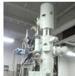
クライオ透過電子顕微鏡 (JEOL 2200FS+Gatan 914 cryo-specimen holder)。生の生物試料の高分解能電顕像を記録する。
