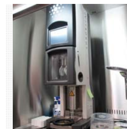
急速凍結装置 (FEI Vitrobot Mark IV)。生の生物試料を急速凍結する。
