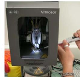
急速凍結装置。湿度をコントロールして、微量の溶液でも乾燥せずに凍結することができる。また、装置を用いることで氷の厚さなどの再現性が増す。
