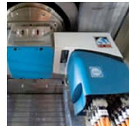
電子直接検出カメラ(Gatan社製K2 ISカメラ)。このカメラを用いることで、解像度の良い動画が撮影でき、像移動を補正した分解能が良い画像が得られる。
