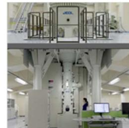
物質・生命科学超高压電子顕微鏡。用いる電子線の高い透過能のために、厚さ数マイクロメートルに及ぶ厚膜試料を高い空間分解能で観察できる。
