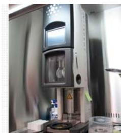
急速凍結装置 (FEI Vitrobot Mark IV)。生の生物試料を急速凍結する。
