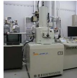
液体窒素冷却試料ステージを組み込んだクライオ走査型電子顕微鏡。凍結切削・凍結切断した試料表面を、凍結状態のまま観察することが可能。
