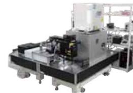
インキュベータ型多光子励起レーザー顕微鏡Olympus LCV-MPEは、光ダメージを抑えつつ、三次元培養細胞や、ES細胞、さらにはマウス胚組織を数日にわたり観察をするために開発されたもので、これら三次元培養、器官培養、胚発生の研究等に威力を発揮します。
