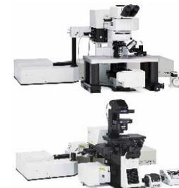
近赤外線パルスレーザーによる励起レーザーシステムInsight DeepSeeを用いた多光子励起レーザー顕微鏡Olympus FV1200MPEは、深部をより明るく、解像度よく、かつ光ダメージを抑えた生体イメージングを可能とします。新標本透明化技術に対応した専用の対物レンズも備えており、最大8mmの解像力の高い三次元画像を撮像することも可能です。
