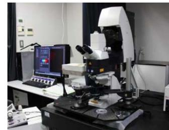
2光子励起用波長可変レーザー Insight DeepSeeを搭載したLeica TCS SP8 MP多光子励起レーザー顕微鏡。こちらもIR-LEGOで誘導後の蛍光観察に利用できる。
