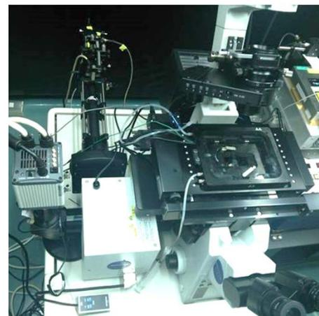
スピニングディスク超解像顕微鏡
