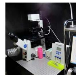
カルシウムなどの細胞内シグナル分子の挙動をLEDストロボ照射により可視化します。多様な分子に対応すべく、システムに改良を重ねています。
