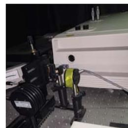
近赤外フェムト秒パルスレーザーを利用する2光子励起効率測定用セットアップ
