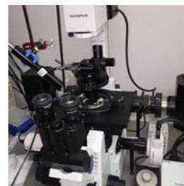
紫外・可視領域光刺激倒立型蛍光顕微鏡。ケージド化合物の光化学的性質測定
