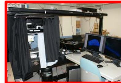
長波長・補償光学対応多光子励起顕微鏡(1号機)、動物実験室内にあり、長期間の継続的観察が可能。
