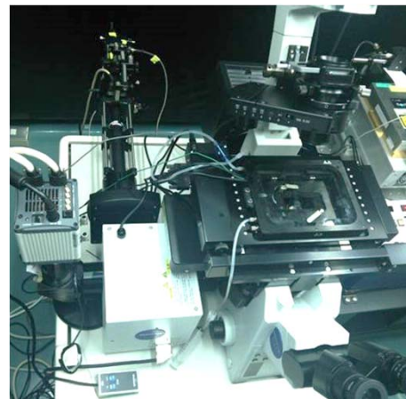
スピニングディスク超解像顕微鏡 (SDSRM) 横河CSUベースの市販機とは異なり、 当研究室でオリンパスと共同開発 したDSUベースのオリジナルです。
