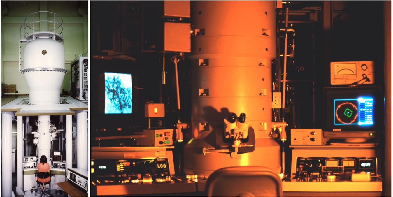
医学生物学用超高压電子顕微鏡(H-1250M 型: 常用加速電圧 1,000kV)
