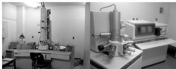
透過型電子顕微鏡(左)、走査型電子顕微鏡(右)(電子顕微鏡室)
