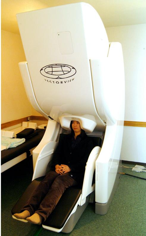
図1 [ELEKTA-Neuromag 社製 306 チャンネル脳磁場計測装置]
