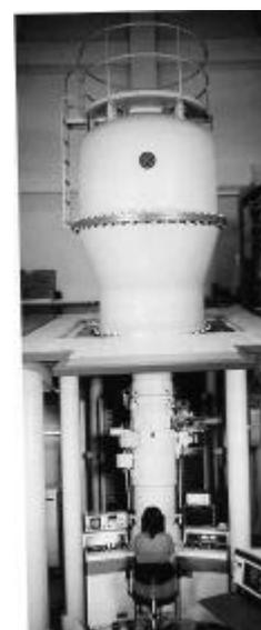
1000kV 超高压電子顕微鏡
