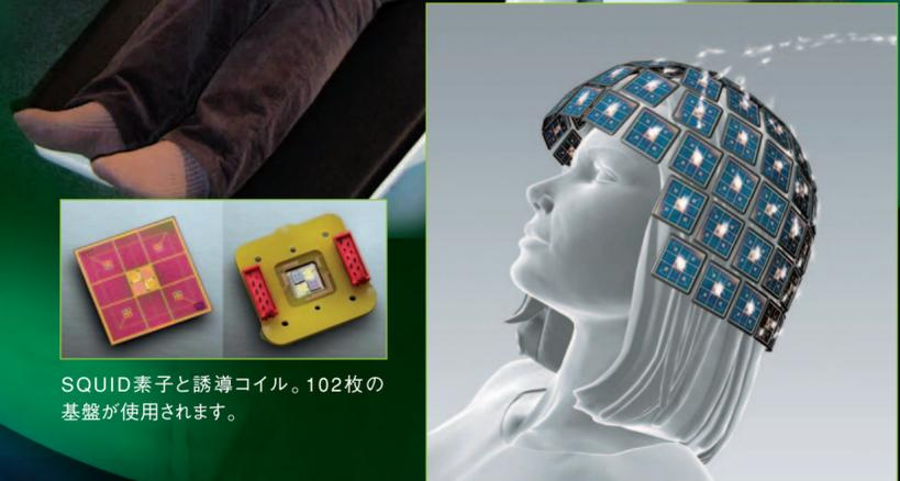
頭部を覆うように306チャンネルのセンサーが配置されていて、同時に脳の全域を計測することができます。
