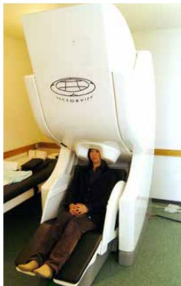
ELEKTA-Neuromag社製306チャンネル脳磁場計測装置
