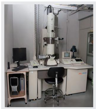
図2 2kx2k CCDカメラを搭載した透過型電子顕微鏡 日本電子製 JEM1010 Fig. 2 Transmission electron microscope (TEM) JEOL JEM1010 equipped with 2kx2k CCD camera
