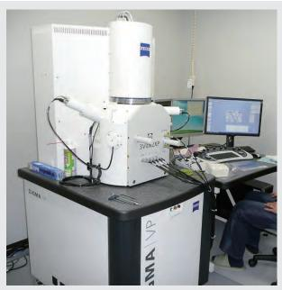
図1 連続ブロック表面走査型電子顕微鏡(SBF-SEM)Gatan 3view - Zeiss SZIGMA/VP
