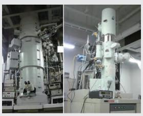
図1 1 MV医学・生物学専用超高圧電子顕微鏡H-1250M(左)と200kVエネルギー分 光型低温位相差電子顕微鏡JEM2200FS(右)
