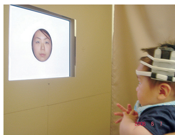
図：乳児用の NIRS プローブを装着して，顔認知時の血流測定
