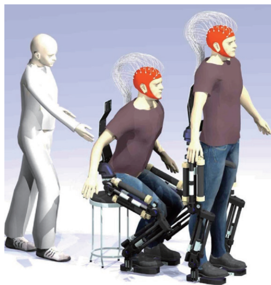
図 : BMI リハのための外骨格ロボット Fig. Exoskeleton Robot for BMI Rehabilitation
