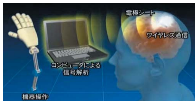
図3 自宅で使用可能な埋め込み型「ワイヤレスシステム」
