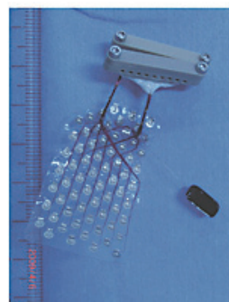
図1：慢性留置型 ECoG 電極と実際のインプラント例 Fig.1 Chronic ECoG array and actual implantation
