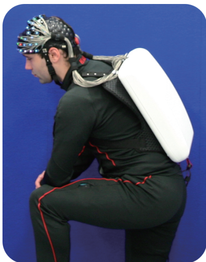
開発したヘッドマウント・ブレインインタフェースを装着した外観:ウェアラブルに脳活動の計測が可能。
