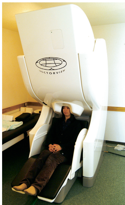
図1 [ELEKTA-Neuromag 社製 306 チャンネル脳磁場計測装置] 306-channel helmet-shaped MEG recording system (ELEKTA-Neuromag, Finland)
