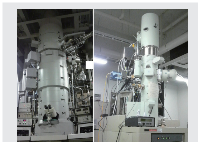
図1. 1 MV 医学・生物学専用超高压電子顕微鏡 H-1250M (左) と 200kV エネルギー分光型低温位相差電子顕微鏡 JEM2200FS (右)
