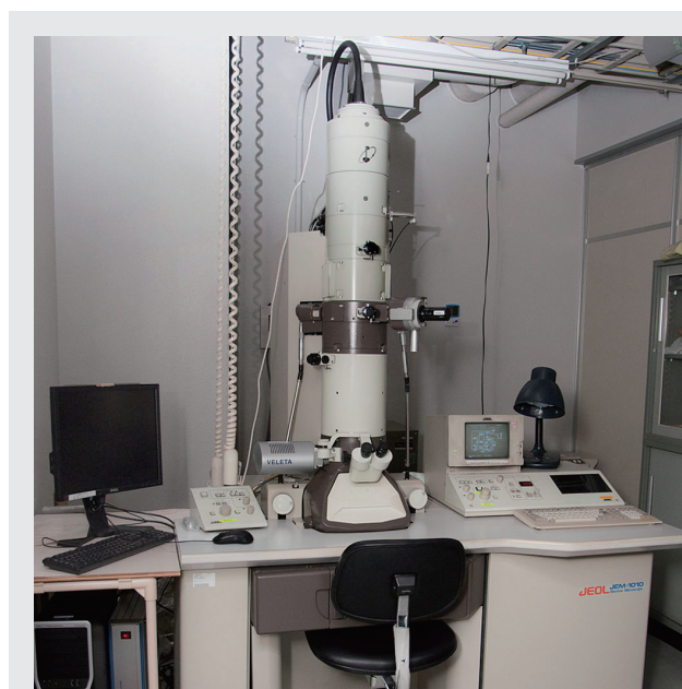
図2. 透過型電子顕微鏡 日本電子製 JEM1010 Fig.2. Transmission electron microscope (TEM) JEOL JEM1010
