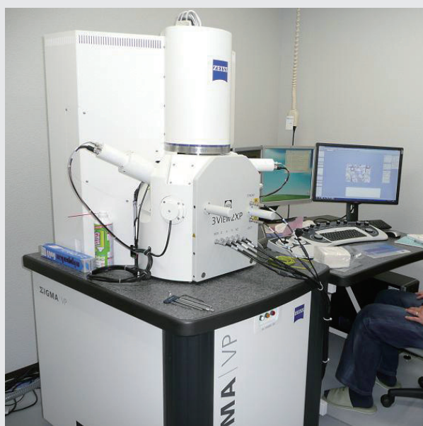
図1. 連続ブロック表面走査型電子顕微鏡 (SBF-SEM) Gatan 3view/Zeiss Σ IGM Fig.1. Serial block-face SEM (SBF-SEM) Gatan 3view/Zeiss Σ IGM
