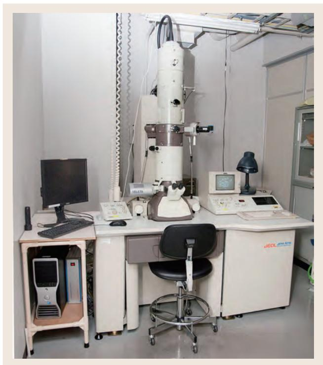
図2 2kx2k CCDカメラを搭載した透過型電子顕微鏡 (JEOL JEM1010)
