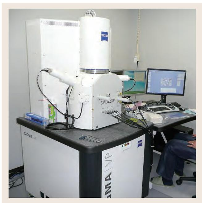
図1 連続ブロック表面走査型電子顕微鏡 (SBF-SEM)
