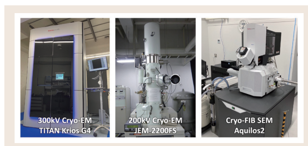
図 1 300 kV クライオ電子顕微鏡 TITAN Krios G4 (左) と 200kV 位相差クライオ電子顕微鏡 JEM2200FS (中), トモグラフィー試料作製装置 Aquilos2 (右)。
