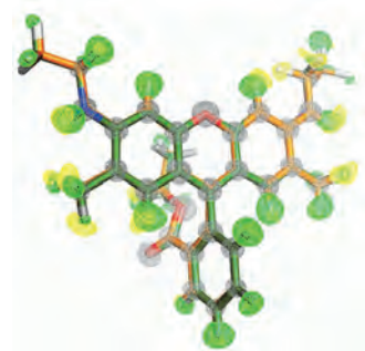
図 2. 蛍光分子の結晶構造の重ね合わせ。緑は XFEL, 黄色は 3D ED からそれぞれ得られた水素原子を表す [3]。
