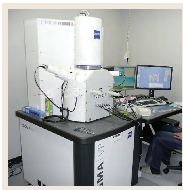
図1 連続ブロック表面走査型電子顕微鏡（SBF-SEM） Gatan 3view - Zeiss \Sigma IGMA/VP
