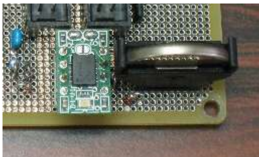
図3 本機内部のバッテリー
