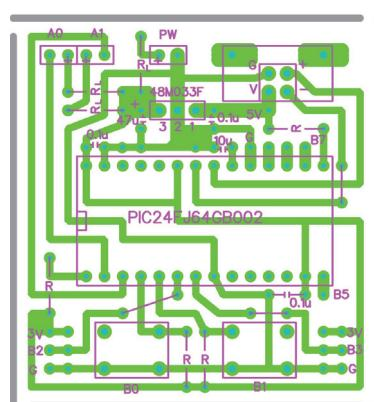
PICのICソケットには、ZIFソケットを使用
